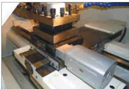
4-х позиционный резцедержатель с автоматической сменой инструмента
