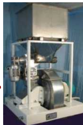
им-266 с питателем - измельчителем пшп-24-05. Производительность до 1,2 т/час печенья некондиции, вафельной обрезки и пр. в качественный возвратный продукт
